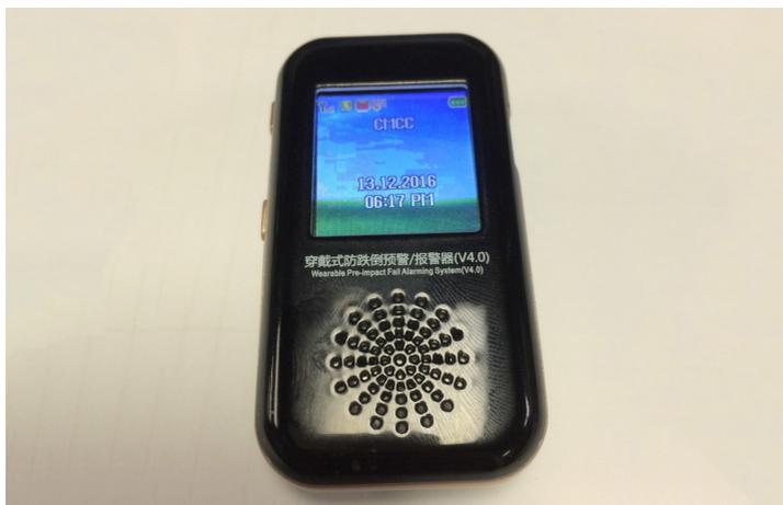
「穿戴式防跌倒預警/報警系統」，基於低功耗MTK硬件平台方案，嵌入高精度9軸慣性傳感器和獨有的防跌倒精準識別算法，可進行老年人日常動作〔走、跑、跳、坐及站的變化等〕識別，失穩動作〔傾斜度過大等〕預警，危險事件〔例如跌倒〕報警等功能，幫助老年人識別運動危險動作，進行多場景的防跌倒預警，提醒和訓練他們，以期實現預防跌倒發生，降低跌倒發生率；另外，系統也可實現跌倒後呼救，報警和位置追蹤等功能。
