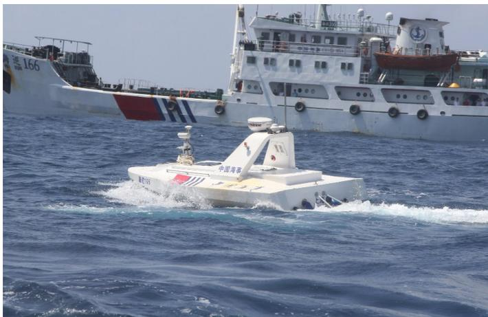
「精海1號無人艇」作為我國第一艘自主研發的水面無人智能測量平台，在2013年隨海巡船赴南海進行了諸島礁海域的測量和監測任務；無人艇自主完成了對南海西沙及南沙諸島礁水下地形地貌及水文情況的測量，為南海島礁設立航海保障基礎設施提供科學依據。
